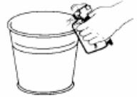
13. Appuyez sur la gâchette du pistolet et pulvérisez dans le contenant à déchets en métal jusqu'à ce que le vieux solvant soit vidangé et que du solvant neuf s'écoule du pistolet.
