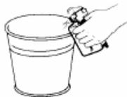
14. Appuyez sur la gâchette du pistolet et pulvérisez dans le contenant à déchets en métal jusqu'à ce que le vieux solvant soit vidangé et que du solvant du pistolet.
