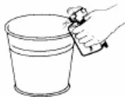
14. Appuyez sur la gâchette du pistolet et pulvérisez dans le contenant à déchets en métal jusqu'à ce que le vieux solvant soit vidangé et que du solvant neuf s'écoule du pistolet.
