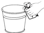
11. Appuyer sur la détente en visant le contenant métallique pour purger le solvant usé du pistolet, jusqu'à ce que du solvant frais en ressorte.
