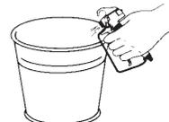
12. Appuyer sur la détente en visant le contenant métallique pour purger le produit du flexible, jusqu'à ce que le solvant s'écoule du pistolet.
