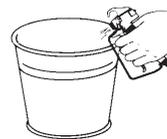
12. Appuyer sur la détente en visant le contenant métallique pour purger le solvant et l'air du flexible de vaporisation, jusqu'à ce que le produit de peinture s'écoule librement du pistolet.
