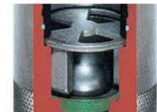
Sièges de billes des clapets d'aspiration et de refoulement réversibles pour doubler la durée de vie. Billes surdimensionnées pour une meilleure aspiration et un meilleur fonctionnement.
